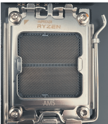
Bild 8: Der moderne AM5-Sockel von AMD unterstützt DDR5-Arbeitsspeicher und den ultraschnellen Standard PCIe 5.0
