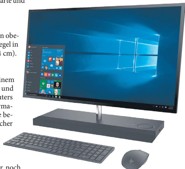
**Bild 3: Bei All-in-One-PCs steckt die Recheneinheit im Monitor oder Standfuß**
